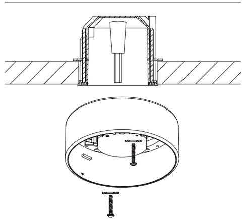
[2] Mit Befestigungsmöglichkeit auf allen Installationsdosen Ø 68 mm
