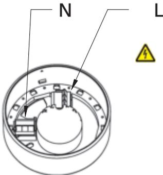
[3] Anschluss 230 V erstellen, dabei Arbeitssicherheit beachten. Mit den Bügeln können die Klemmen entriegelt werden. Betrieb nur mit verriegelten Bügeln.
