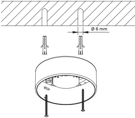
[1] Gehäusesockel auf ebenem festem Grund montieren. Das beiliegende Montagmaterial ist ggf. anderen Untergründen anzupassen.
