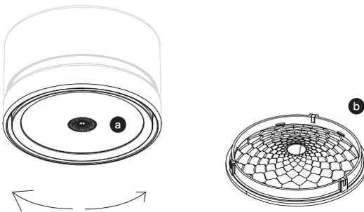
[7] Der Linseneinsatz (a) wird von drei Magneten in der Leuchte gehalten, mit einer leichten Drehung des Linseneinsatzes in der Leuchte (1) werden die Magnete getrennt und der Linseneinsatz b) fällt heraus.
