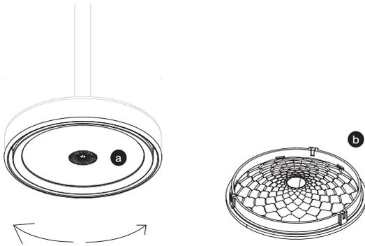
[8] Der Linseneinsatz (a) wird von drei Magneten in der Leuchte gehalten, mit einer leichten Drehung des Linseneinsatzes in der Leuchte (b) werden die Magnete getrennt und der Linseneinsatz (b) fällt heraus.
