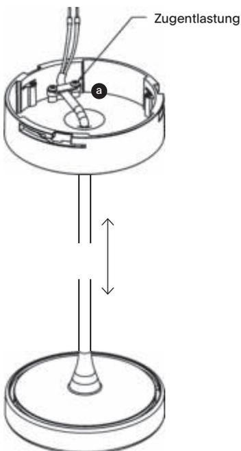
[8] Lösen Sie die Schrauben der Zugentlastung (a) und stellen Sie die Leitung auf die gewünschte Pendellänge ein. Die Aderenden absetzen und mit den beiliegenden Endhülsen verpressen.
