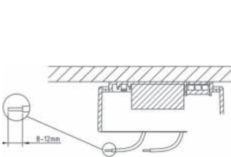
[3] Stromkreis freischalten, Arbeitssicherheit beachten! Kürzen Sie das 230-V-Wechselstromkabel und entfernen Sie 8 mm der Isolierung der Aderenden von L und N.
