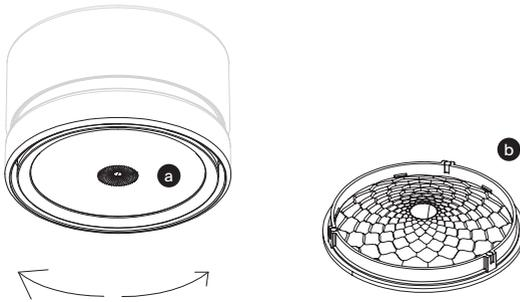
[8] Der Linseneinsatz (a) wird von drei Magneten in der Leuchte gehalten, mit einer leichten Drehung des Linseneinsatzes in der Leuchte (b) werden die Magnete getrennt und der Linseneinsatz (2) fällt heraus.
