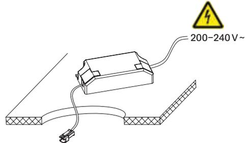
[1] Den entsprechenden Stromkreis freischalten, trennen Sie die Stromversorgung im Innenbereich
