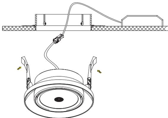
[7] Die Installation mit Putzeinbauring bitte ab Schritt 1 gemäß separater Anleitung erstellen.
