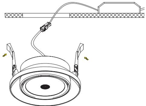
[3] Verbinden Sie den Treiber und die Lampe mit den Steckverbindern.
