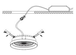
[4] Beide Federbügel nach oben drücken und das Downlight in die Decke setzen
